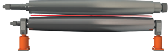
Bükme kalınlığı silindir bombesinden daha incedir Bending thickness is thinner than roll crowning
